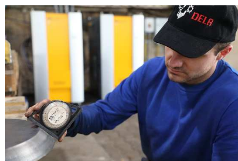
DELA Anlagenführer Jonas Schulz prüft die Schnittqualität der Flansche.
