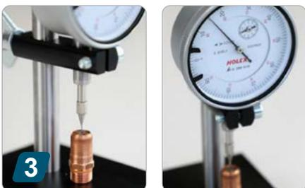
Messung: Hülse anheben, Messstift auf zurückgebrannten Kathodenstift setzen
