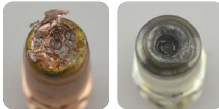
Maximaler Rückbrand der Kathode überschritten, falsches Schneidgas genutzt
