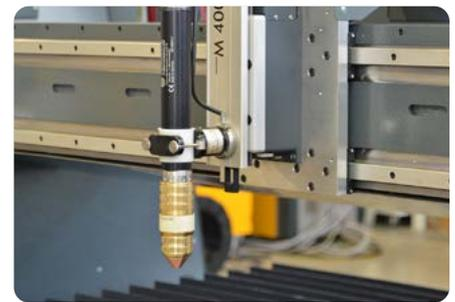
Der passende und konstant gehaltene Abstand zwischen Plasmabrenner und Werkstück ist entscheidend für die Qualität der Schnittergebnisse, die Lebensdauer der Verschleißteile und die Prozessstabilität.
