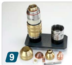
**9** Prüfen, ob Verschleißteile beschädigt oder verschlissen sind
