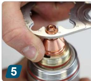
**5** Düse zusammen mit der Gasführung mittels Brennerwerkzeug herausziehen
