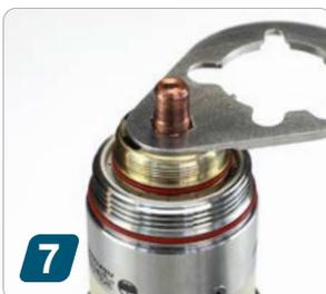
**7** Kathode mit Hilfe des Brennerwerkzeuges heraus-schrauben
