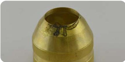
Schutzkappe durch Doppellichtbögen beim Schneidabbriss beschädigt
