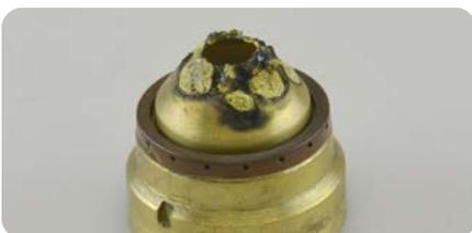
Düsenkappe aufgrund einer beschädigten Wirbelgaskappe zerstört
