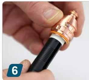
**6** Mit Gasführungszieher Gasführung aus Düse herausziehen (bei Verklebten erst eindrücken)
