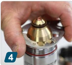
**4** Mit Brennerwerkzeug Düsenkappe abschrauben
