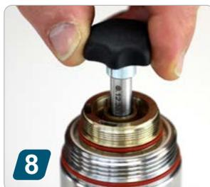
**8** Kühlrohr mit Steckschlüssel heraus-schrauben (bei Änderung Kathodentyp)
