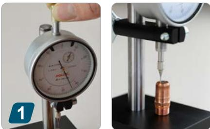
Nullstellung: Hülse anheben, Messstift auf Kathode setzen
