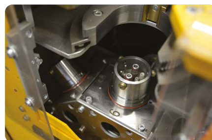
ATChanger: magazine para 8 cabeçotes de tocha ATChanger: cargador para 8 cabezales de antorcha
