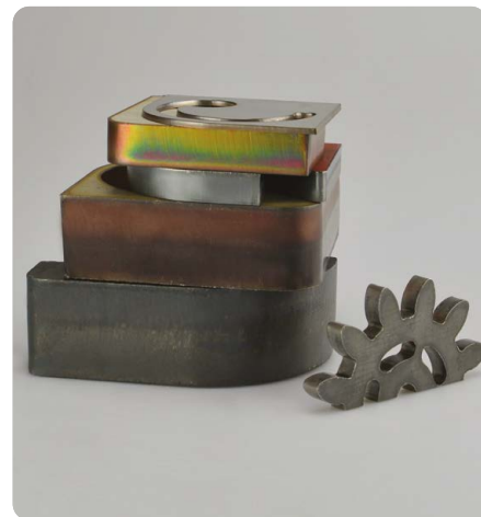
Corte de 0,5 a 160 mm | Corte de 0,5 a 160 mm
