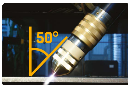
Corte chanfrado até 50° | Corte en bisel hasta 50°
