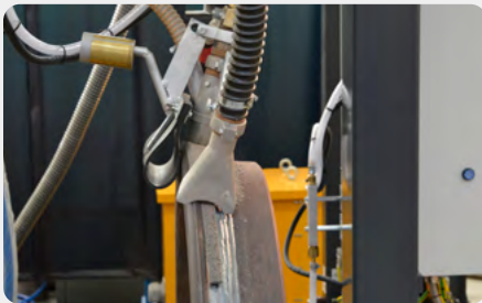
Pulverdüse im Einsatz
