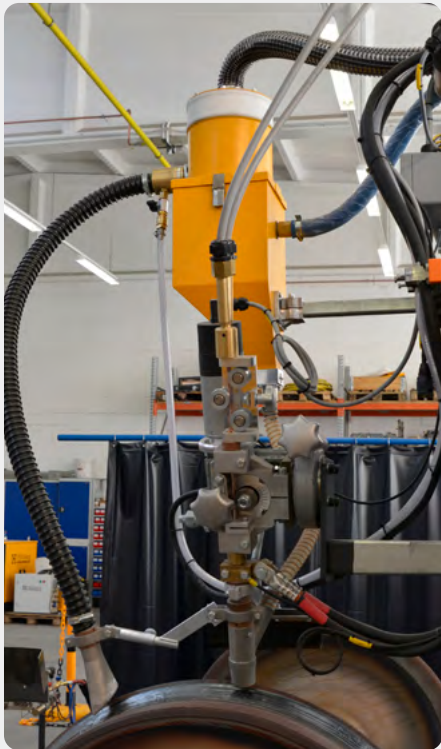
Pulveranlagen 6 l mit manueller Pulverabsper- rung, Sieb und Zuführschlauch
