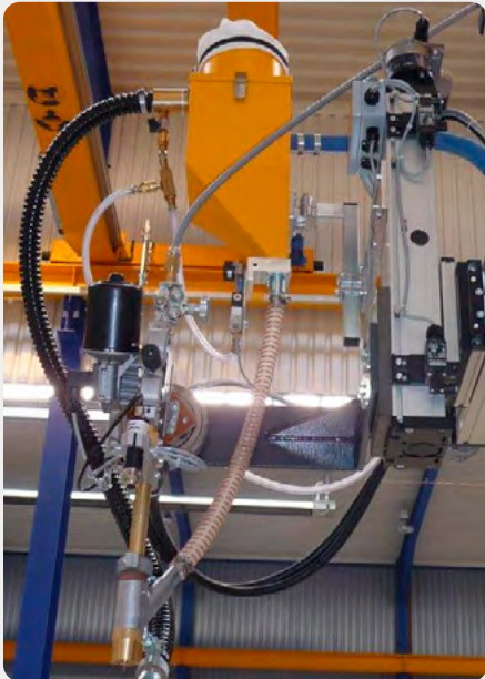
Pulverbehälter 10 l mit Pulverzuführ- und Saugschlauch
