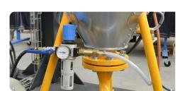
Wartungseinheit für Druckluft
