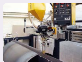
KA 2-UP zum Längsnahtschweißen mit Badsicherung
