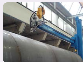
Systemlösung: Schweißmast mit KA 2-UPP zum Längsnahtschweißen an Rohren
