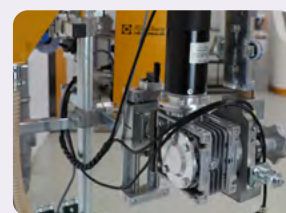
Robustes Vorschubgetriebe für Draht bis Ø 5,0 mm
