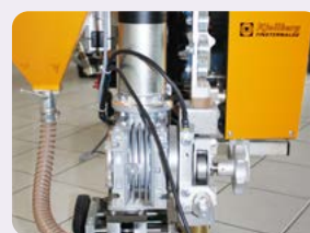
Robustes Vorschubgetriebe für Draht bis Ø 5,0 mm
