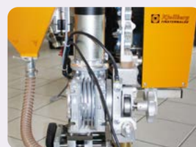
Robustes Vorschubgetriebe für Draht bis Ø 5,0 mm
