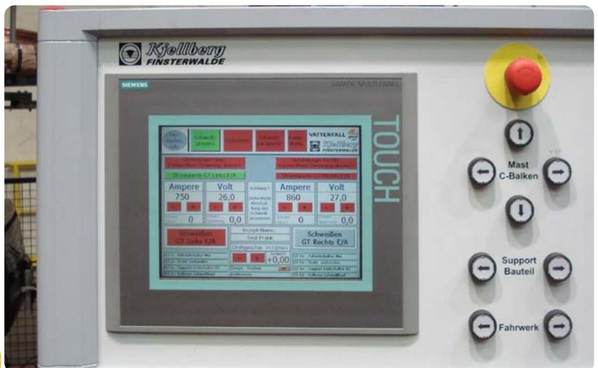
Herzstück der elektrotechnischen Erneuerung ist das zentrale Bedienpult für die Steuerung der mechanischen Komponenten und des Schweißprozesses
