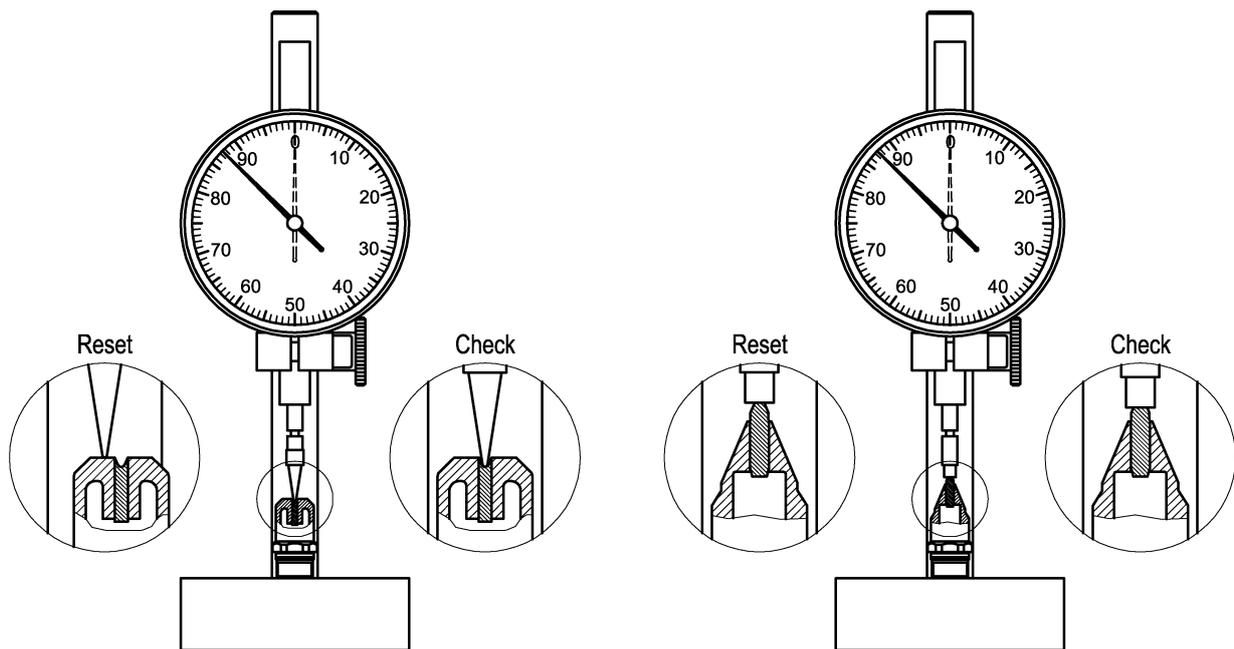
Prüfung mit spitzem Messuhrtaster
