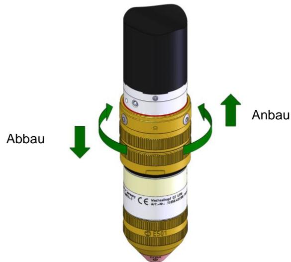
3. Legen Sie den Wechselkopf auf eine weiche Unterlage ab und sichern Sie ihn gegen Wegrollen. Empfehlenswert ist die Verwendung der „Parkstation für Wechselkopf des Brenners“.
