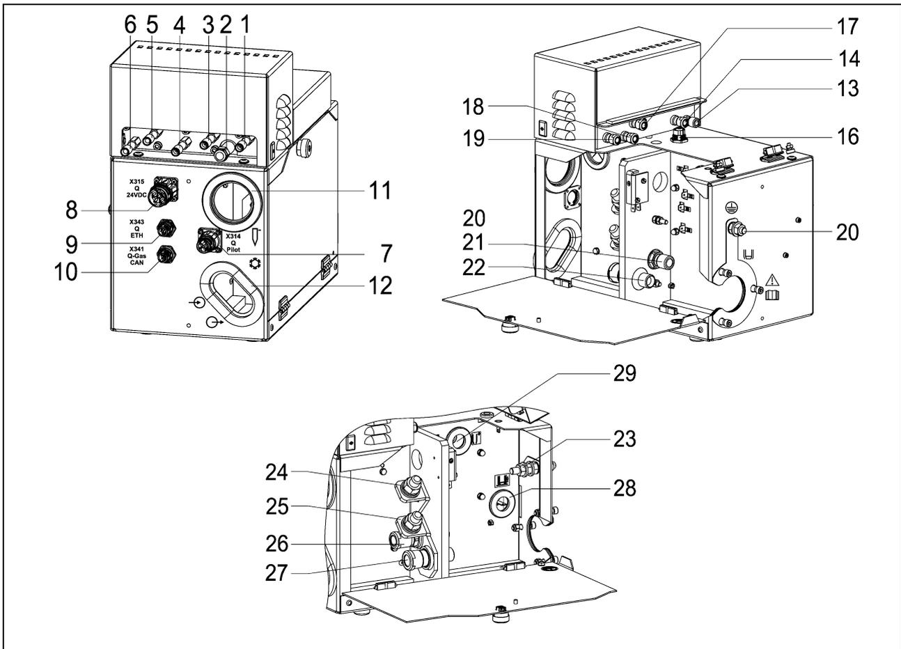
**Abb. 38: Anschlüsse des Q-Port**
