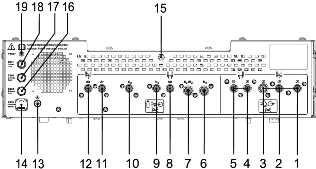
Abb. 24: rückseitige Anschlüsse der Q-Gas
