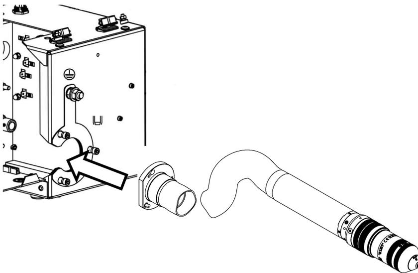
Achten Sie auf guten elektrischen Kontakt des Flansches mit dem Gehäuse, um die während des Zündvorganges entstehende Hochfrequenz optimal abzuschirmen.
