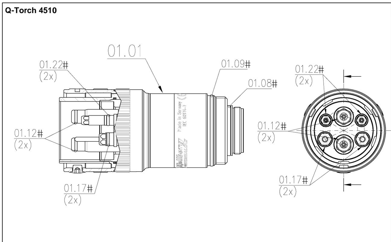
**Abb. 35: innere und äußere O-Ringe des Wechselkopfes**
