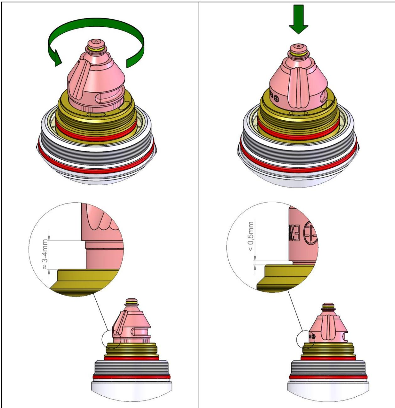
Abb. 33: Einsetzen der Düse in den Brennerkopf
