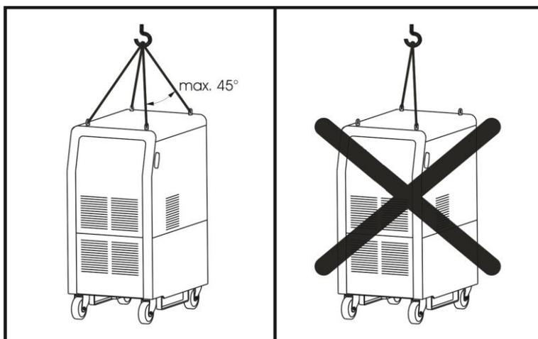
Für den Krantransport ist das Gerät mit Kranösen ausgerüstet.
