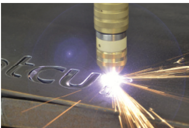
Bild: Kjellberg-SilentCut.jpeg – Baustahlschneiden mit reduziertem Schalldruckpegel mit Silent Cut
