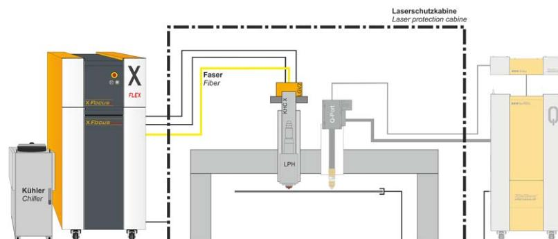
Anschlussystem: Einsatz am Führungssystem im Wechsel mit Plasmaschneidanlage möglich
