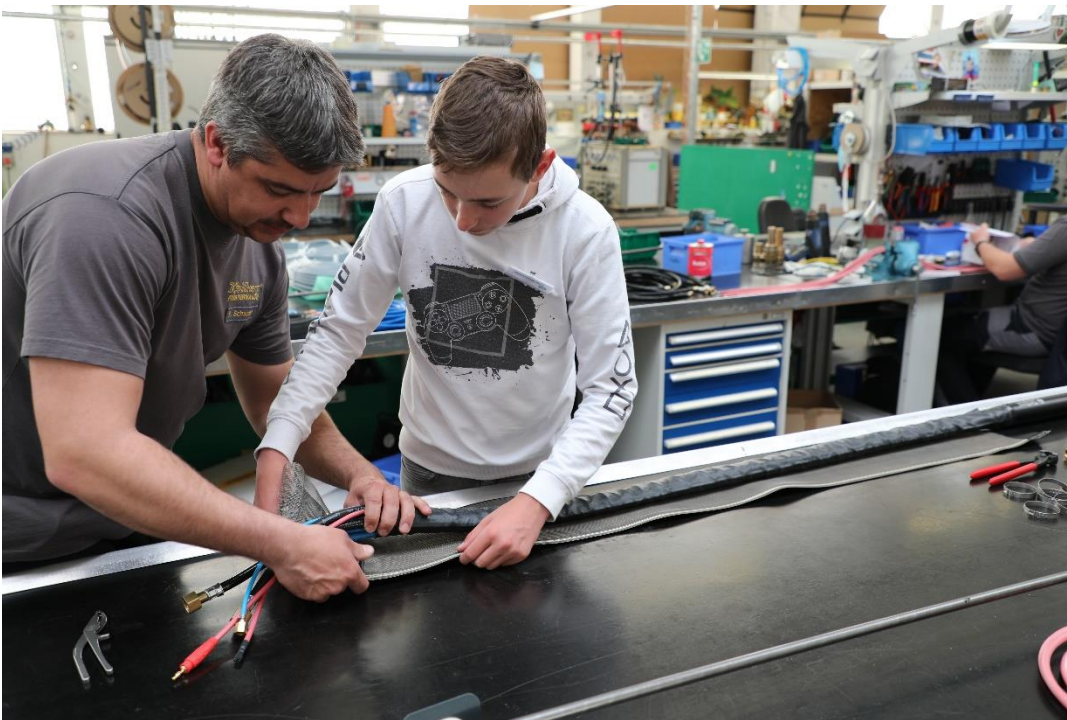
Bildunterschrift: Jonas Bilke und René Schwinge (Mitarbeiter Brennerbau) bauen das Schlauchpaket für einen Plasmabrenner zusammen. (© Foto: Kjellberg Finsterwalde)
