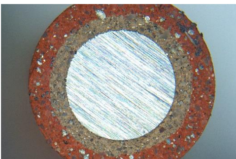
Bild 1: Kjellberg-Doppelmantelelektrode Duoweld: rutil Hülle außen, basische Umhüllung innen (© Foto: Kjellberg Finsterwalde)
