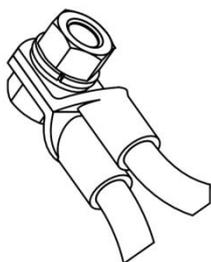
**Abb. 18: Anschluss externe Katodenleitungen 2x50 mm<sup>2</sup>:
