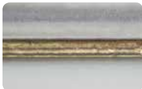
Perfekte Nahtoberflächen selbst bei beschichteten Oberflächen, v = 3 m/min
