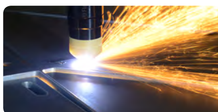
Mechanisiertes Plasmaschneiden mit Flash 100 Mechanised plasma cutting with Flash 100
