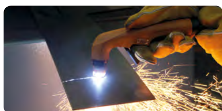
Manuelles Plasmaschneiden mit KjellCut 70 Manual plasma cutting with KjellCut 70
