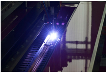
Bild 3: InFocus-Schweißen auf einer Längsnahtschweißmaschine im Schweißtechnik-Anwendungszentrum
