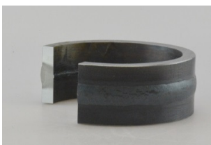
Bild: Querschnitt einer InFocus-Schweißprobe
