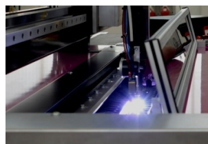
Bild: InFocus an einer Längsnahtschweißanlage
