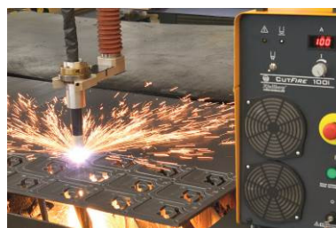
Bild: Baustahlschneiden mit Flash 101
